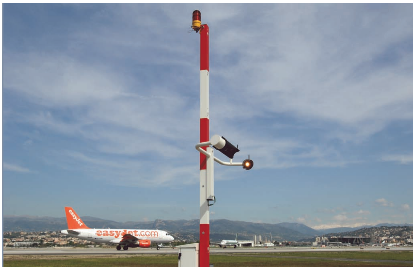
Diffusomètre sur l'aéroport de Nice, dans les Alpes-Maritimes.
