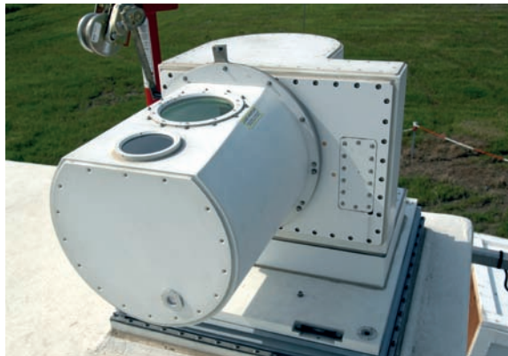
Scanner du Lidar vent LMCT, en tir vertical, en expérimentation à Nice, en mai 2009.
