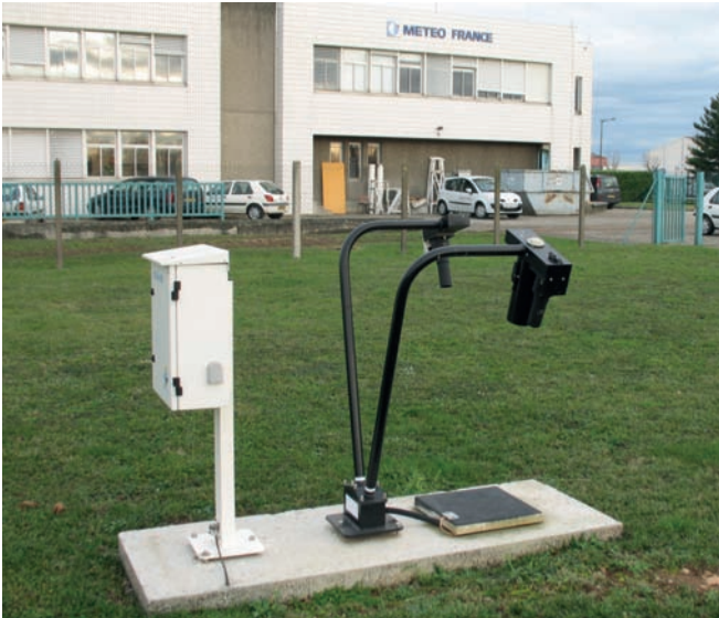
À gauche, capteur d'état de sol Solia 300 installé à Lyon Bron dans le département du Rhône.
