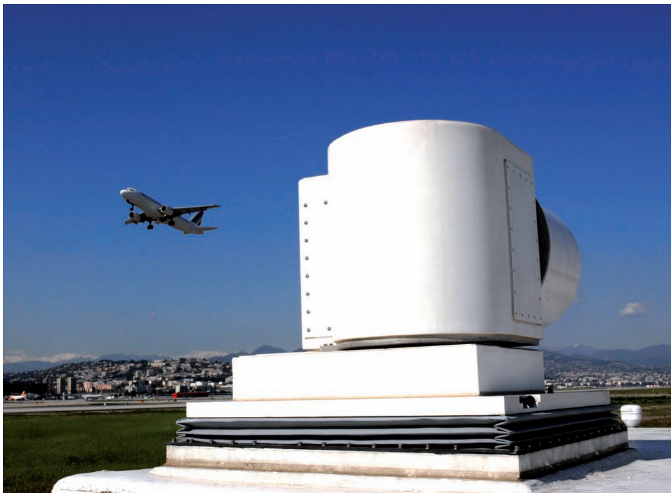
Lidar en expérimentation sur l'aéroport de Nice dans les Alpes-Maritimes
