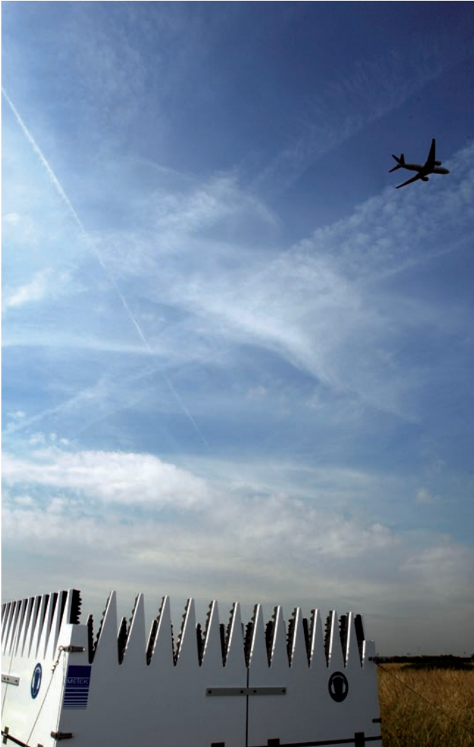
Sodar installé à l'aéroport Paris-Charles de Gaulle dans le Val-d'Oise, pour mesurer les profils de vent dans les basses couches de l'atmosphère.
