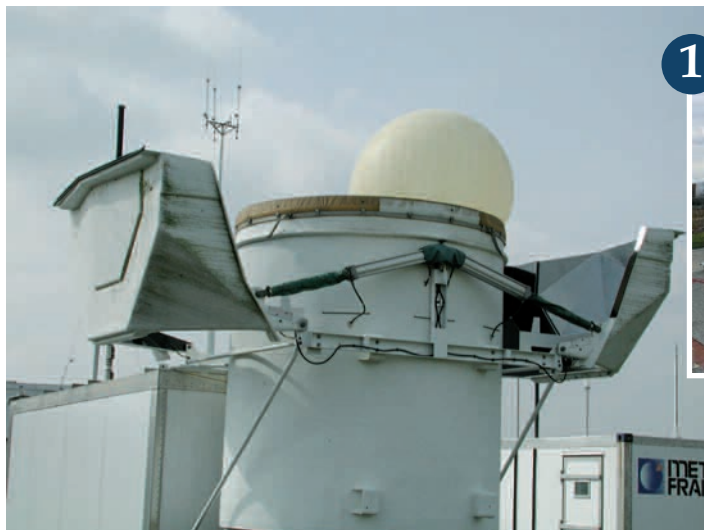
▲ Autosonde Vaisala déployée à Bordeaux pour la réalisation automatique des radiosondages.
