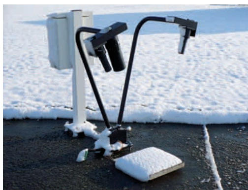
◀ Capteur d'état du sol Solia, fournissant des informations sur la présence d'une couche de neige. (© Météo-France)
