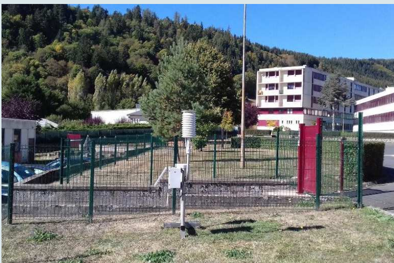
La station automatique de Murat (Pulsia IV de la société Pulsonic) a été installée à l'entrée du Lycée Joseph Constant, en remplacement de la station manuelle qui se trouvait sur le site de la gendarmerie, à 200 m de là.
